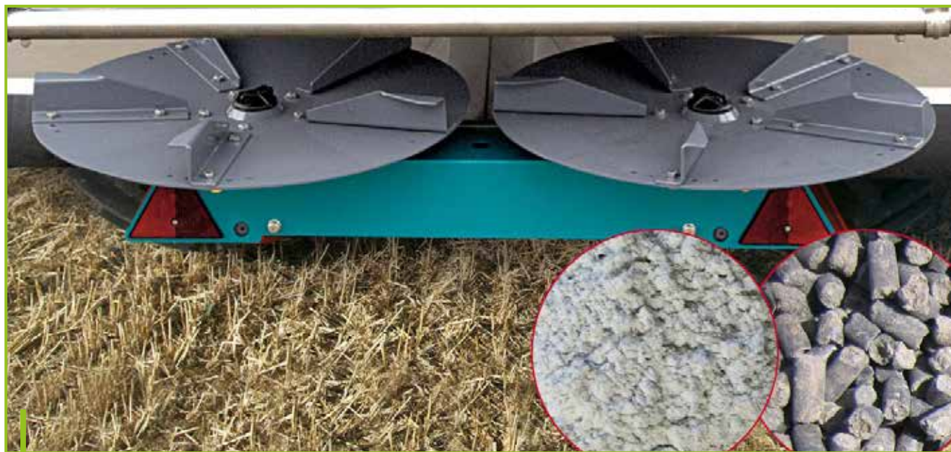
Chaulage d'entretien : ces disques acier de 700 mm de diamètre conviennent pour des produits grossiers à épandre entre 3 et 5 tonnes/ha.
