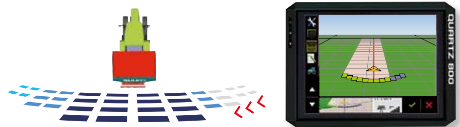
Si la largeur d'épandage se réduit, lors du dernier passage par exemple, les sections se ferment automatiquement en fonction de la largeur restant à épandre (ici 3 sections fermées côté droit)
