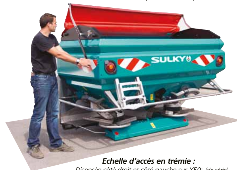
Bâche à enrouleur : à commande manuelle ou à commande hydraulique (1 DE) depuis la cabine (option)
