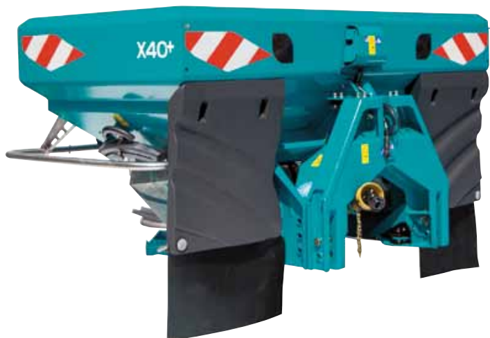
Carters pare-boue en matière composite inaltérable (de série) et extensions souples (option) : une protection totale contre les projections de terre lors des épandages à haute vitesse en conditions humides et un nettoyage facilité
